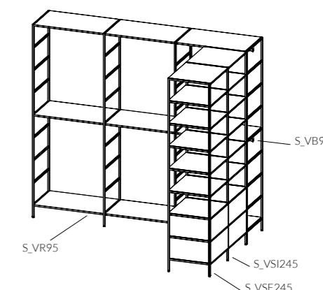
L'angolo cabina armadio viene realizzato sovrapponendo due elementi - come da schema - e fissati con piastra di collegamento nei fianchi.
